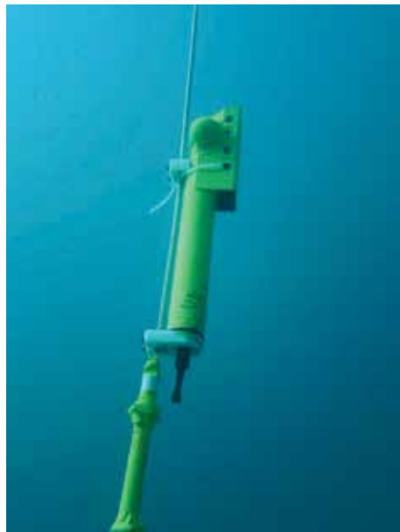
Figura 8 - Ejemplo de línea corta, boya e instrumentos unidos.
