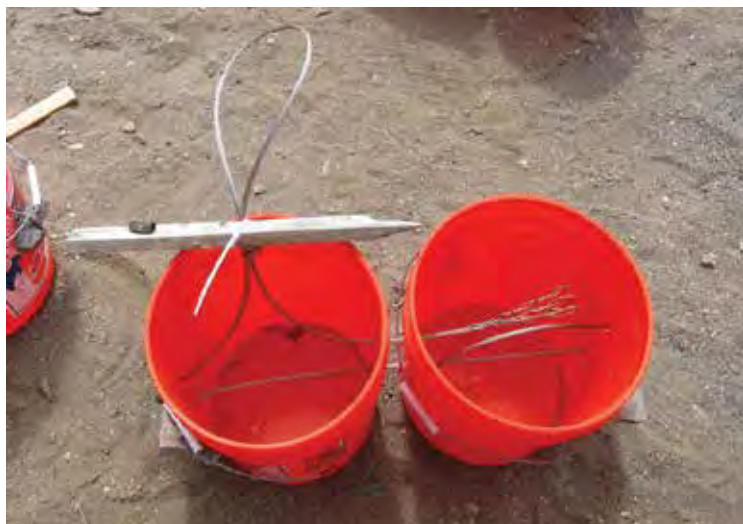
Figura 5 - Ejemplo de cómo unir dos cubetas mediante cable de acero.
