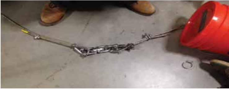
Figura 7- Unión de cubetas a línea principal mediante un destorcedor o grillete giratorio
