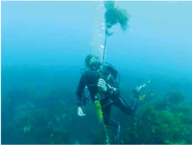
Figura 8 - Ejemplo de línea corta, boya e instrumentos unidos.
